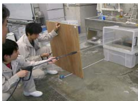
写真-1 洗い出し作業の様子
